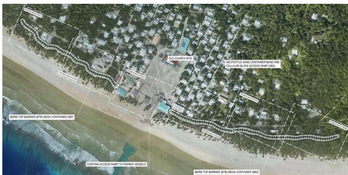
Figura 3.3: design del progetto di protezione costiera sull'isola di Nanumaga. La discontinuità è data dalla rampa di accesso alla spiaggia, anch'essa innalzata. Fonte: UNDP
