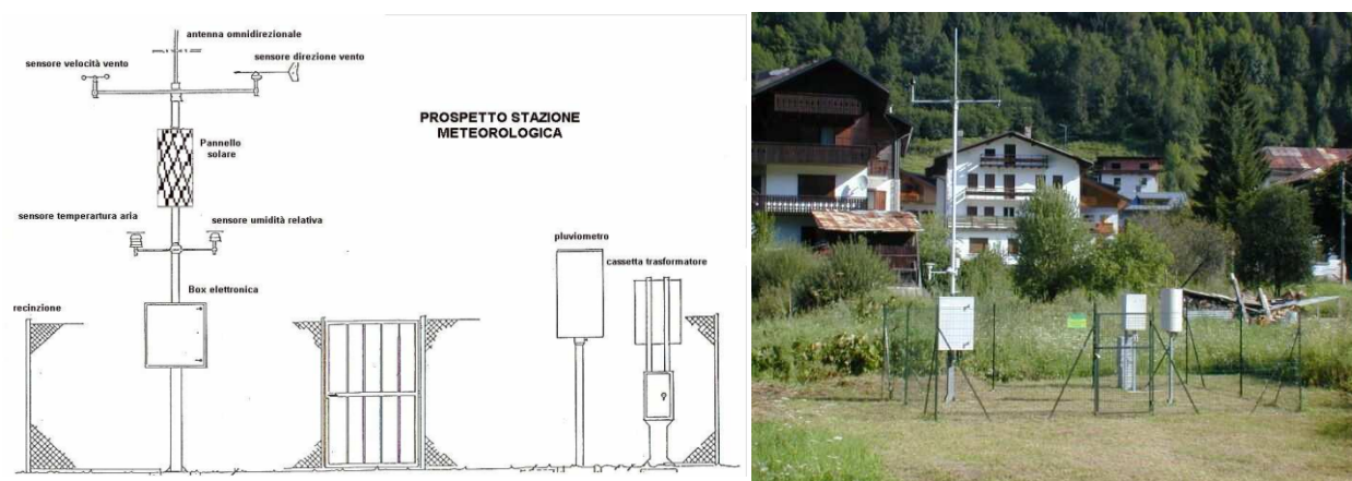
Figura 2.2: Prospetto di una stazione meteorologica e foto illustrativa
