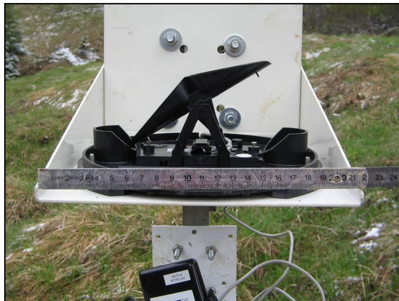
Figura 2.1: Pluviometro a bascula
