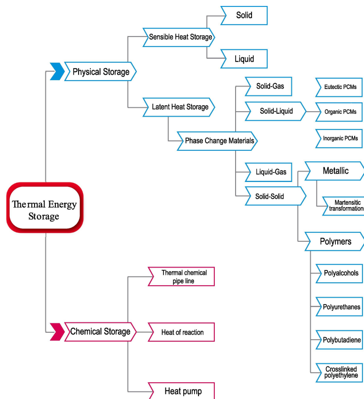
Figura 1.3: Tipologie di accumulo di energia termica [8].
