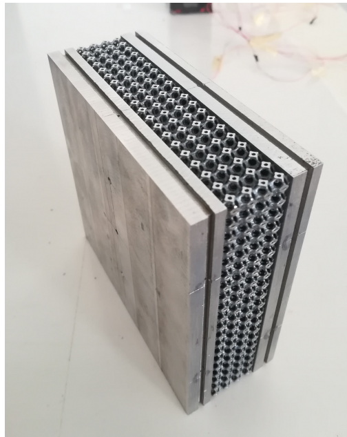
Figura 2.9: Geometria BCC finale con lato del cubo di 5 mm.
