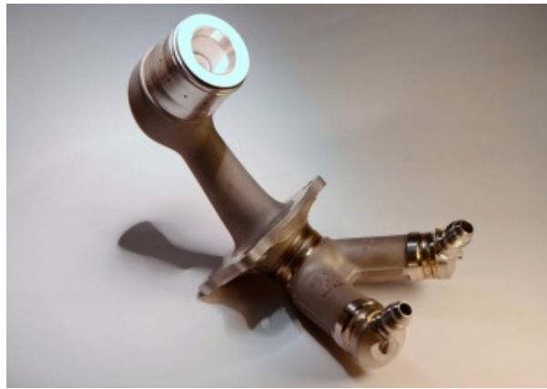
Figura 1.19: Ugello carburante GE Aviation prodotto in modo additivo [34].
