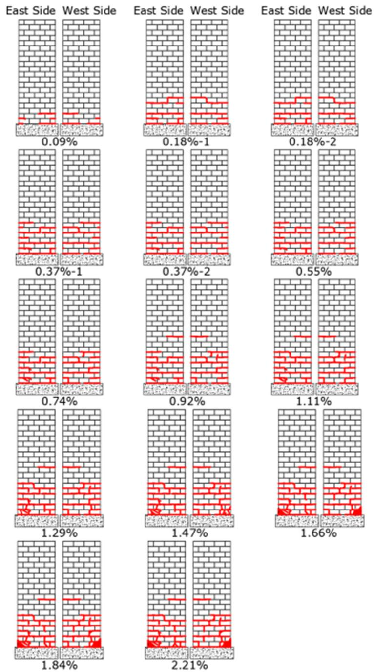
Figura 5-11: Comportamento fessurativo campione W4
