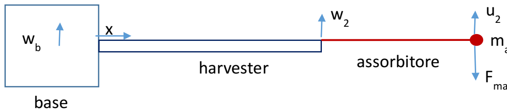
Figura 3.16: modello fisico per lo studio analitico della configurazione harvester + assorbitore
