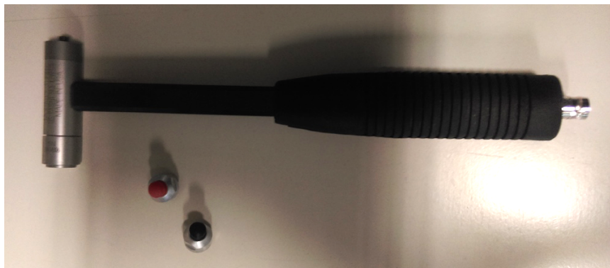
Figura 4.5: martelletto strumentato adottato durante l'esecuzione delle prove sperimentali e le relative punte utilizzate
