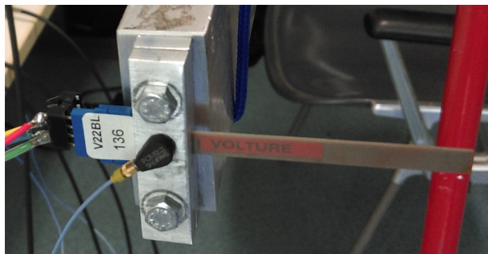
piastra V22BL sulla quale si sono eseguite le misure
