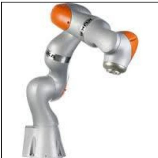
sei assi azionati tramite motore elettrico e dopo numerosi successi e studi innovativi portò nel 2013 a costruire il primo robot sensitivo atto alla collaborazione uomo-robot, LBR iiwa (Fig. 4.1.1), ove "LBR" sta per "robot leggero e "iiwa" per "intelligent industrial work assistant" [19].
