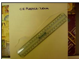
“Figura 35. Esempio corpo estraneo di plastica dimensioni >10cm”
