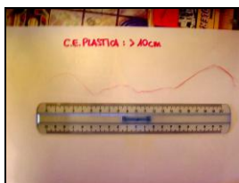
“Figura 47. Esempio corpo estraneo di plastica dimensioni >10cm”
