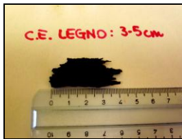
“Figura 25. Esempio corpo estraneo: legno dimensioni 3-5cm”
