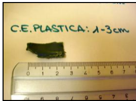
“Figura 29. Esempio corpo estraneo di plastica dimensioni 1-3cm”
