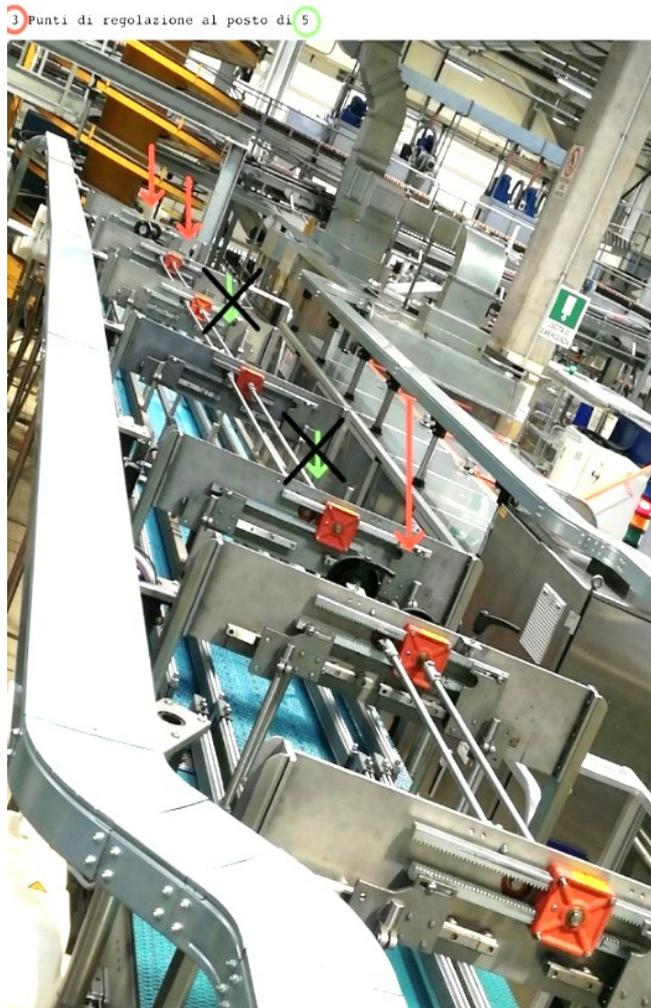
Figura 40, Fotografia relativa all'intervento migliorativo che consiste nel nuovo sistema di regolazione dei nastri trasportatori
