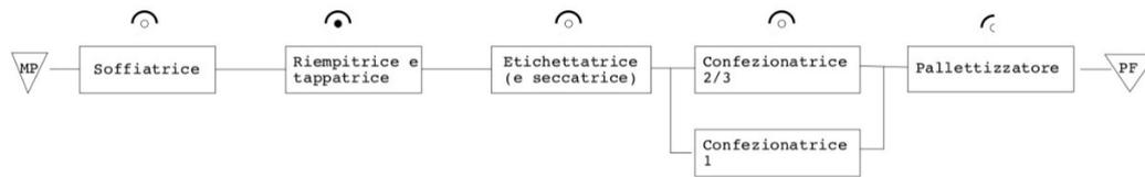
Figura 19, Rappresentazione schematica delle postazioni di lavoro della linea 42
