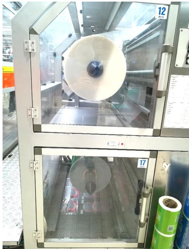
Figura 43, Fotografia di uno dei due sistemi di cambio bobine dell'impianto 42
