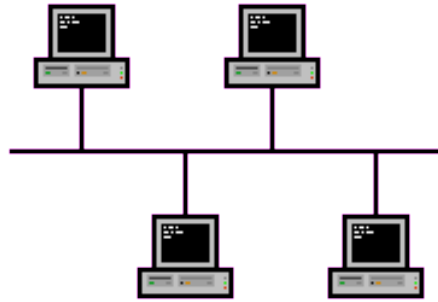
Figura 30: Schema di rete Ethernet semplice.
