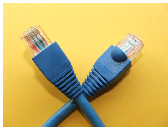
Figura 31: Esempio di cavo Ethernet con doppini intrecciati e connettori RJ-45.
