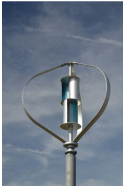
(c) Esempio di turbina ibrida Darrieus-Savonius..
