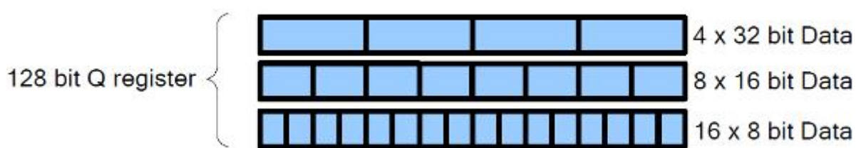
Figura 3.12: Possibili costruzioni di array Q da 128 bit
