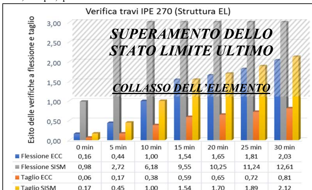
Figura 4.31 a) – Esito delle verifiche effettuate sulle travi della struttura non dissipativa (EL)
