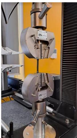
**Figura 2.13.** Instron serie 5969 equipaggiata con prese meccaniche di trazione con azione a cuneo serie 2716-015 a bassa forza.
