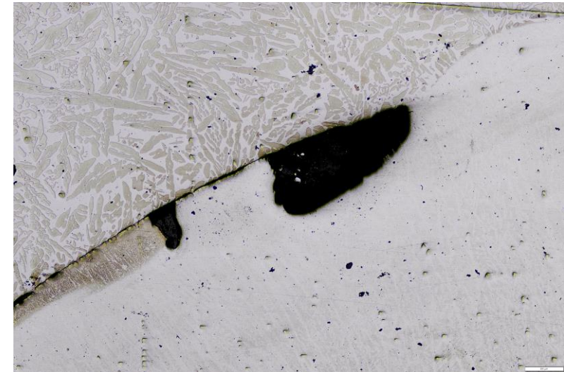
Micrografia della saldatura a 50x con vilella
