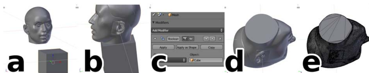
Figura 4.4: Miglioramento della chiusura del collo.
