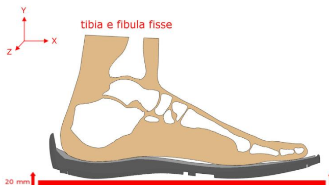
Figura 91: Condizioni di carico e vincolo del modello.
