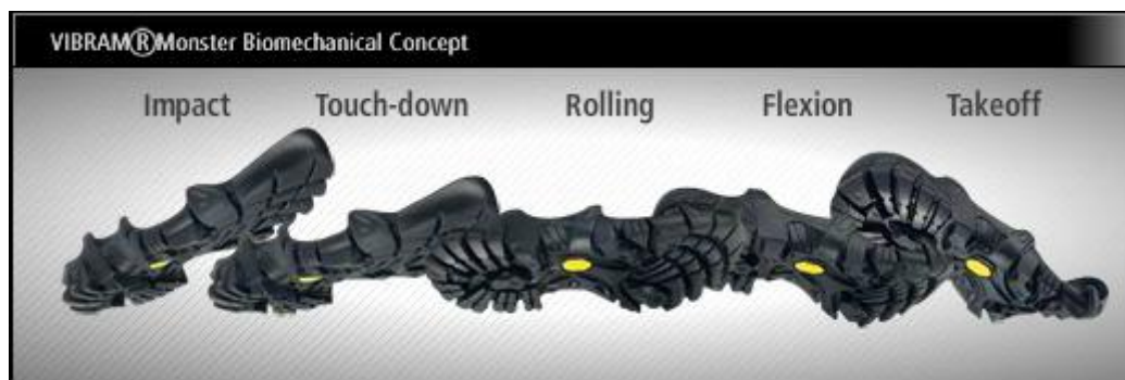
Figura 38: Fasi del Monster Biomechanical Concept. Impact: tallone smussato asimmetrico per un agevole primo contatto; Touch-down: comoda rullata per un atterraggio naturale; Rolling: struttura interna ad "S" per una rullata ergonomica; Flexion: chiodi direzionali per una flessione potenziata; Takeoff: punta articolata per una trazione sicura e dinamica.
