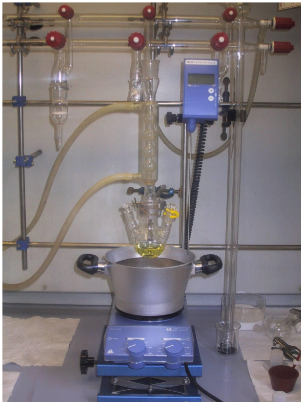
Figura 6. Apparecchiatura usata per lo stress termico degli oli.
