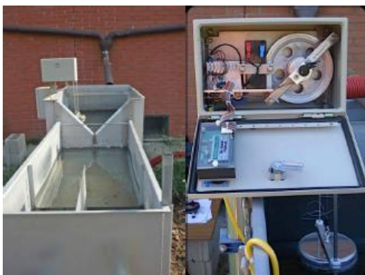
Figura 3.3 Vasca di raccolta dell'acqua e scatola data logger.
