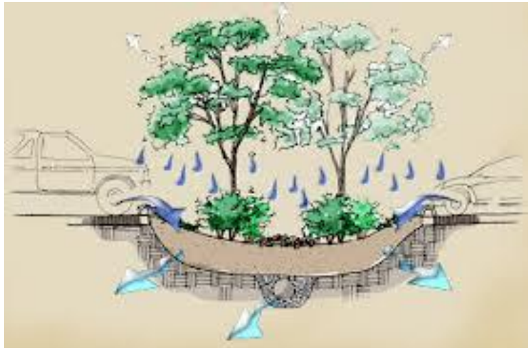
Figura 2 Sezione longitudinale di una struttura bioretention.
