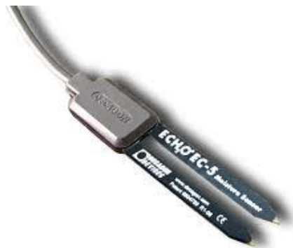
Figura 4 Sonda utilizzata per la rilevazione dell'umidità lungo il profilo del terreno
