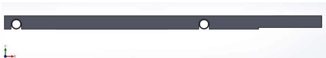
Figura 4.18: vista frontale del cold plate in cui si possono notare i tubi del circuito di raffreddamento.
