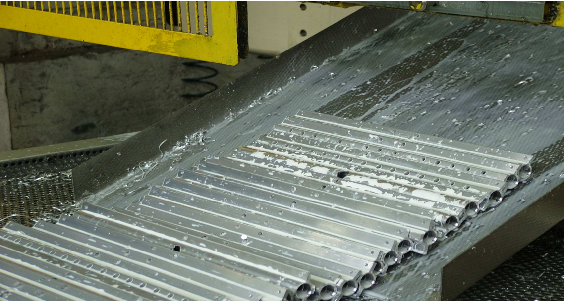
Figura 9 Rampe gas all'uscita del macchinario ATEC
