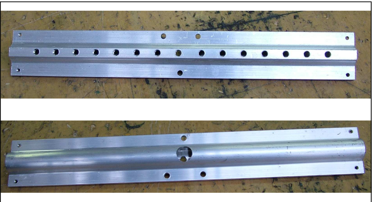
Figura 10 Rampa gas prima dell'assemblaggio.
