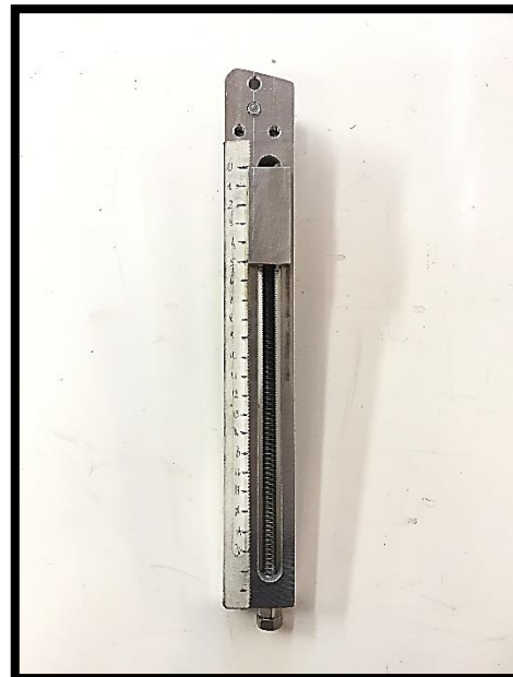
Figura 3.4 Vista laterale e frontale della staffa di regolazione sinistra assemblata
