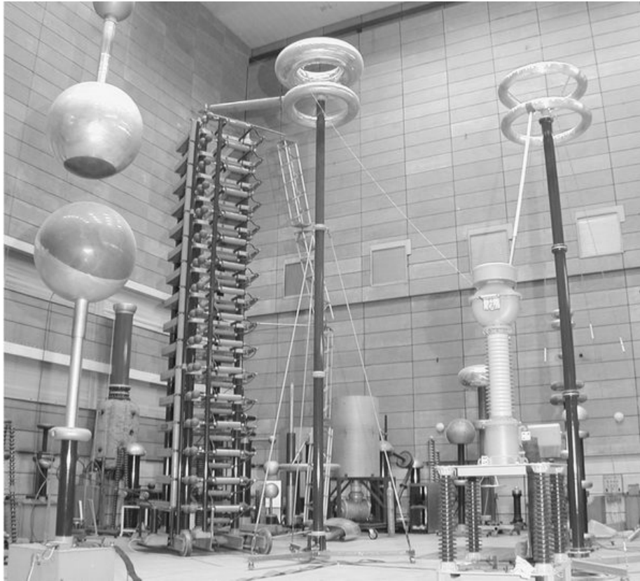
Figura 7 – Generatore di Marx con tensione nominale di 3.2 MV
