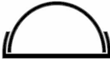
Figura 2.7 Geometria della sonda semicilindrica alternativa alla sonda triangolare.
