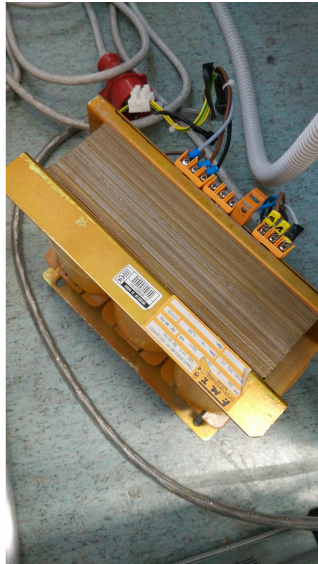
Figura 13: Trasformatore di isolamento
