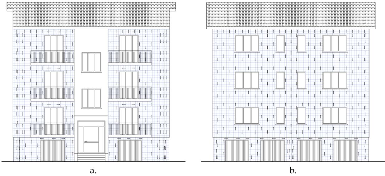
Figura 4.17 Intonaco armato con rete elettrosaldata su due lati: a) prospetto est; b) prospetto ovest.
