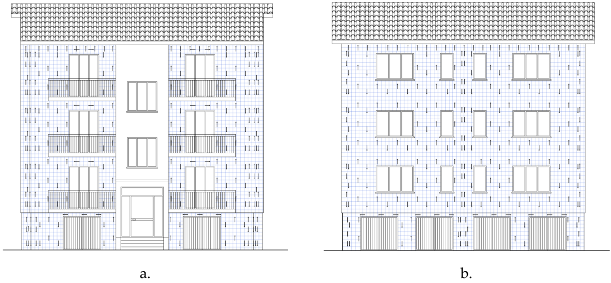
Figura 4.8 Intonaco armato con rete elettrosaldata su due lati: a) prospetto est; b) prospetto ovest.
