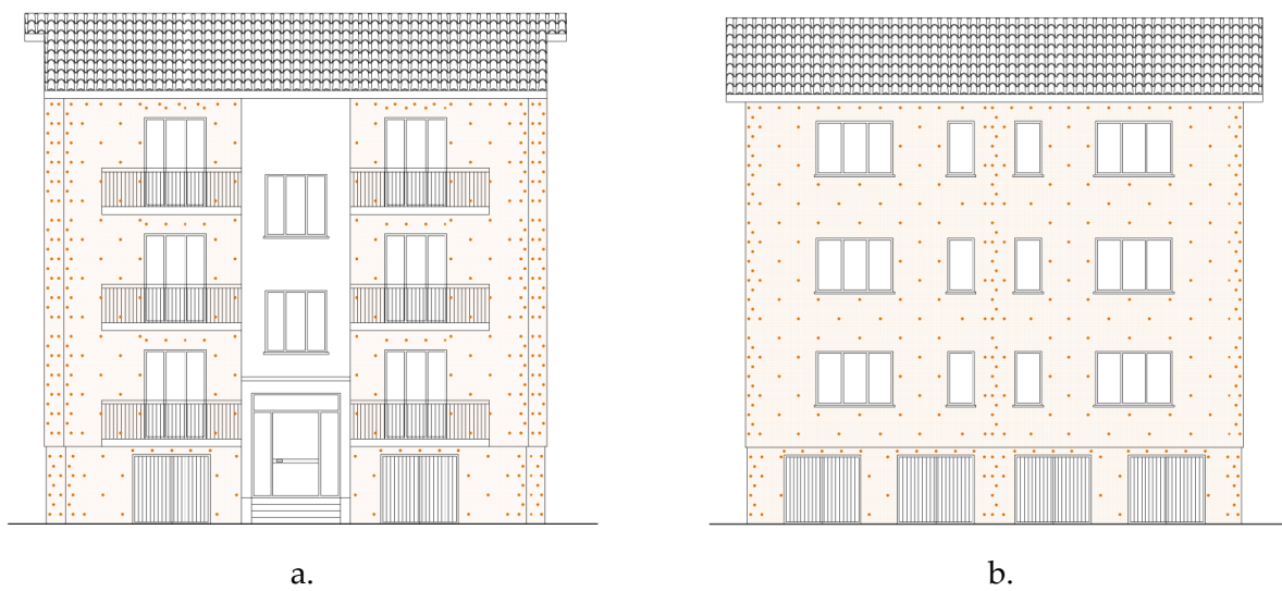
Figura 4.27 Intonaco armato con rete elettrosaldata su due lati: a) prospetto est; b) prospetto ovest.
