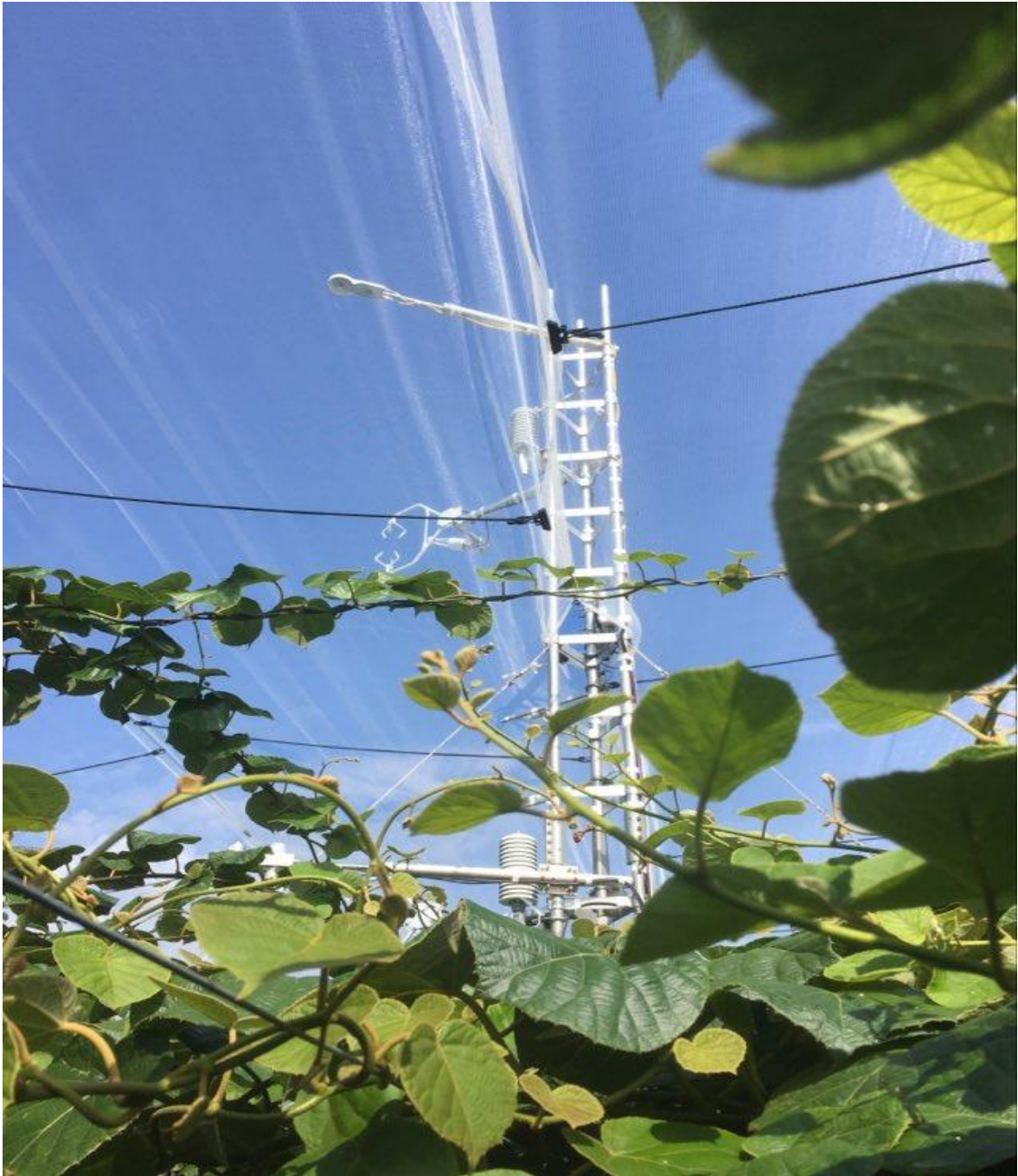
Figura 1. Foto scattata nel frutteto di kiwi in cui sono state effettuate le misurazioni. In alto, verso il cielo, si intravedono le pieghe della rete trasparente disposta a protezione della coltura di A. deliciosa . La rete e le chiome sono attraversate dal traliccio, il quale sorreggere la strumentazione adibita alle misurazioni degli scambi di energia e materia tra la coltura e l'atmosfera.
