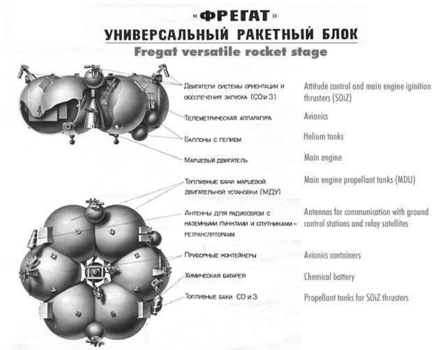
Immagine 2: schematizzazione dello stadio Fregat proposta da russianspaceweb.com
