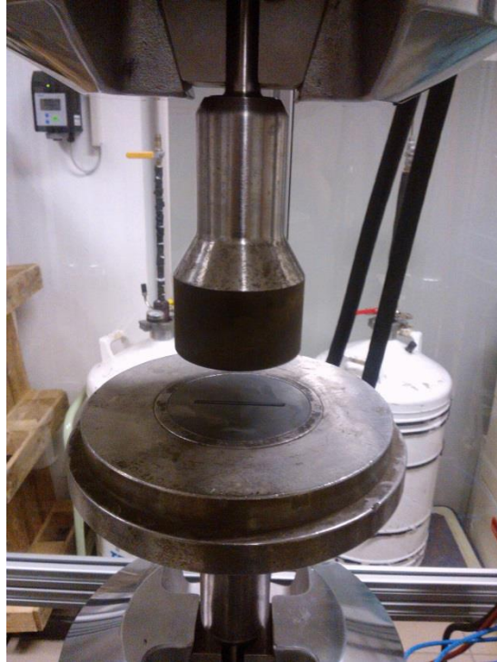
Fig. 5.20 Composizione del set-up di prove utilizzato: punzoni adattati e matrice rivestita in TiN
