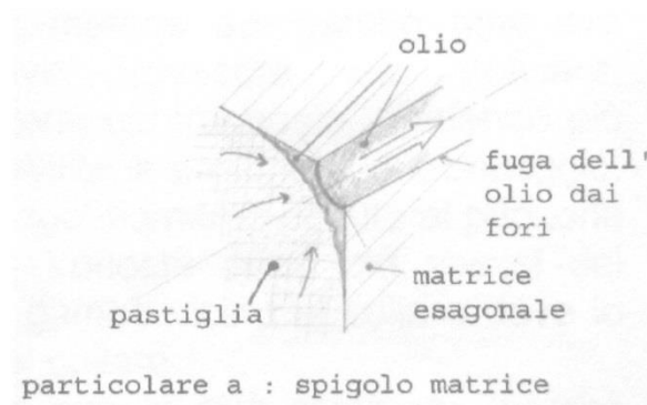
Fig. 3.6 Particolare del foro di scarico dell'olio nel vertice esagonale
