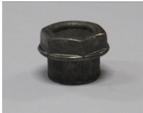
Fig. 3.10 Tappo stampato in stazione singola
