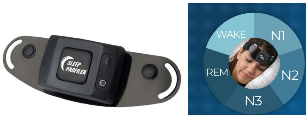
Figura 3.2: Dispositivo Sleep Profiler con esempi di applicazione. In evidenza i tre elettrodi posizionati sull'area frontopolare.
