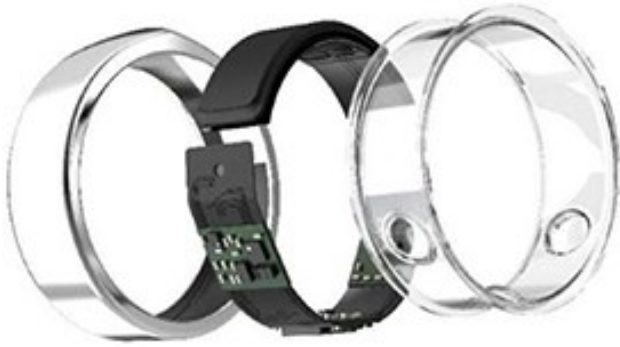
Figura 3.3: Oura Ring in dettaglio. L'anello è rivestito esternamente da una copertura in titanio; le componenti elettroniche presenti sono una batteria, un processore, una scheda di memoria, due LED, un fotorilevatore ed è dotato di connettività bluetooth per un'applicazione utilizzabile su smartphone.
