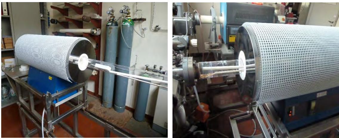
Figura 2.4 Forno cilindrico per processo diffusivo, con tubo al suo esterno (a) e tubo al suo interno (b)
