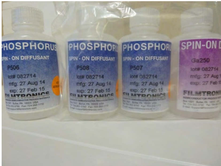
Figura 2.6 Soluzioni a disposizione per il drogaggio del germanio
