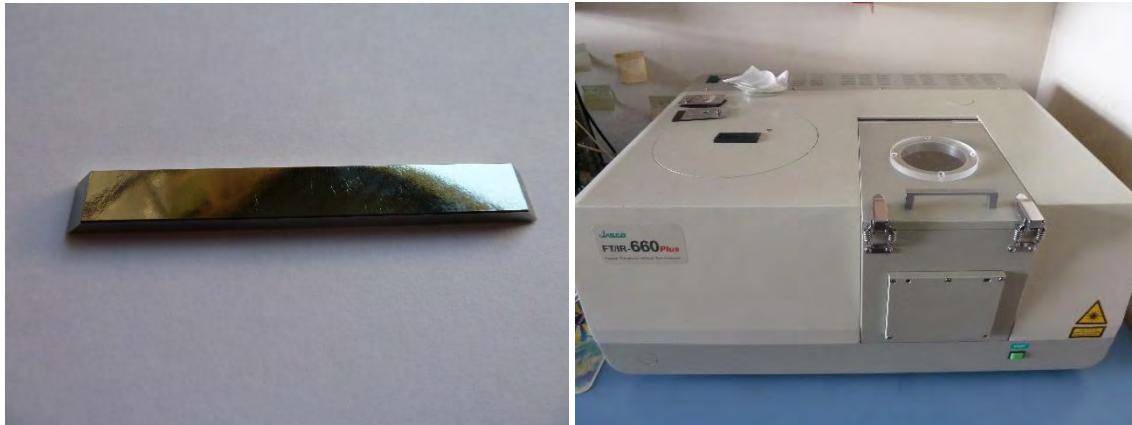
Figura 3.2 Cristallo di germanio usato per prove di pulizia (a) e spettrometro Jasco FT-IR 660 Plus per caratterizzazione FT-IR (b)
