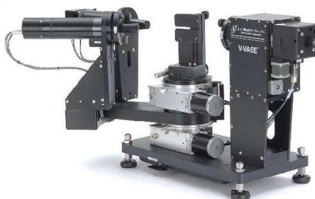
Figura 3.10 Immagine dell'ellissometro utilizzato per le misure di spessore e di indice di rifrazione.
