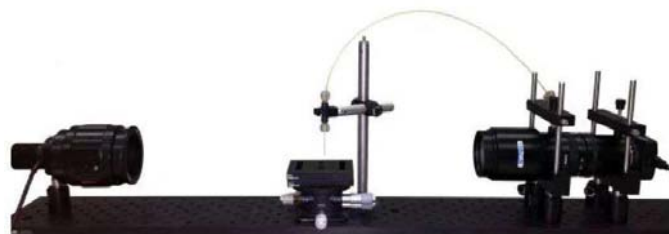
Figura 3.13 Postazione operativa della misura dell'angolo di contatto. A sinistra è posizionata la fonte della luce, al centro il campione con la siringa, a destra la fotocamera.
