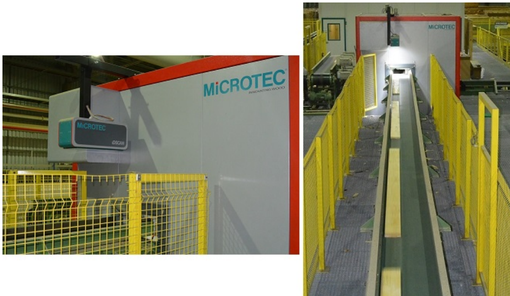
Figura 7.1: Sistema iNKLESS iDSCAN in funzione. Berneck Stazione 1
