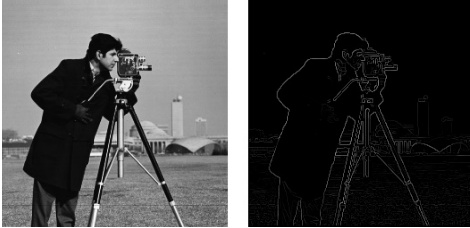
Figura 3.2: Canny edge detection. A sinistra l'immagine di input, a destra il risultato ottenuto applicando Canny.
