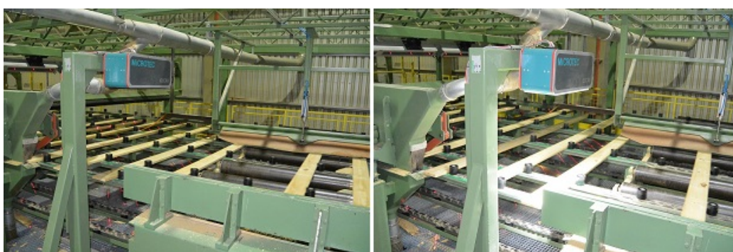
Figura 7.2: Sistema iNKLESS iDSCAN in funzione. Berneck Stazione 2
