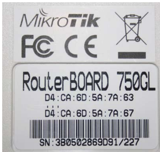
Figura 8.3: Indirizzi MAC address stampati sotto la scheda
