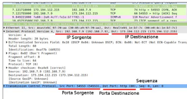
Figura 10.4: Analisi pacchetti con wireshark di una connessione telnet
