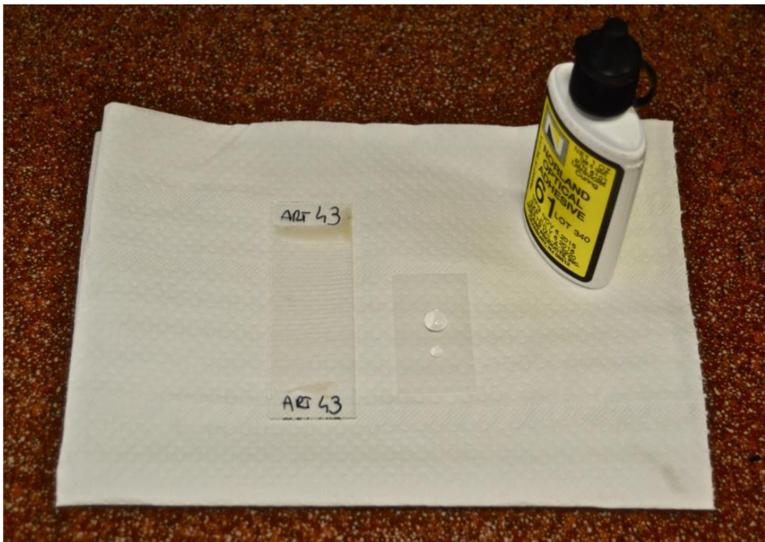
Fig. 7.7 - Goccia di adesivo ottico Norland sul vetrino portaoggetti
