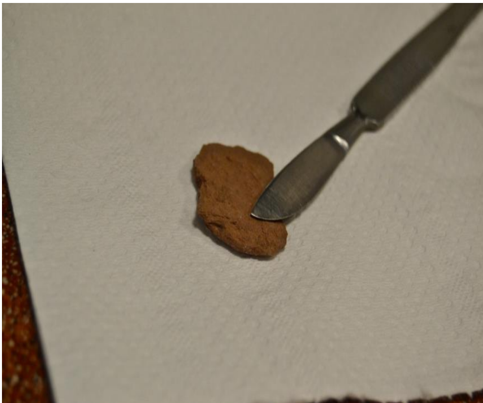
Fig. 7.1 - Prelievo di materiale con il bisturi dal testimone
