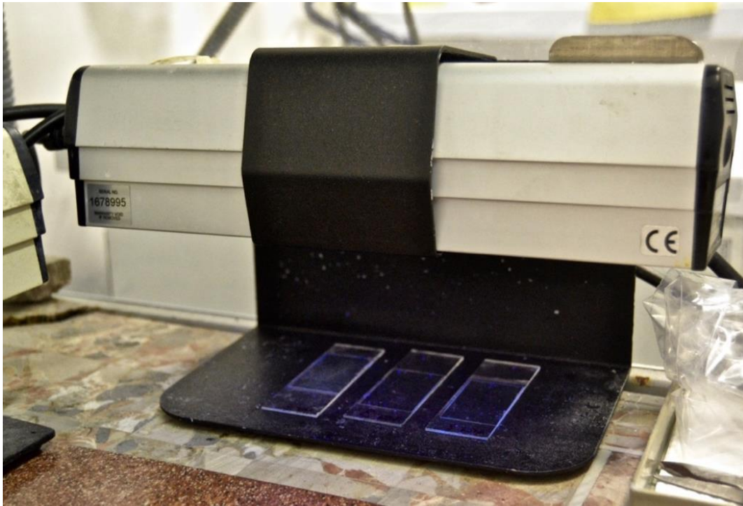
Fig. 7.8 - Fase di consolidamento della colla sotto la lampada a raggi UV.
