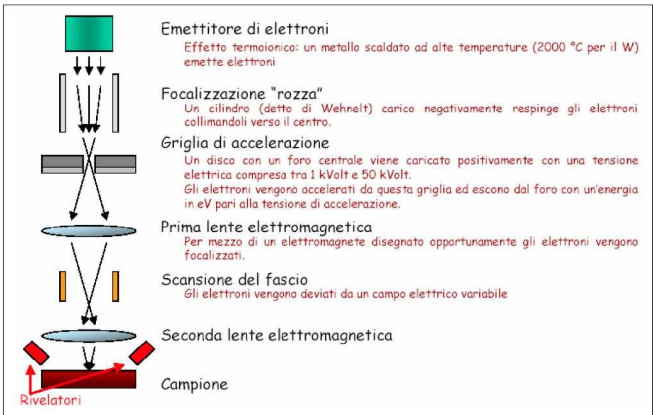
Fig. 8.4 - Schema di un apparato SEM
