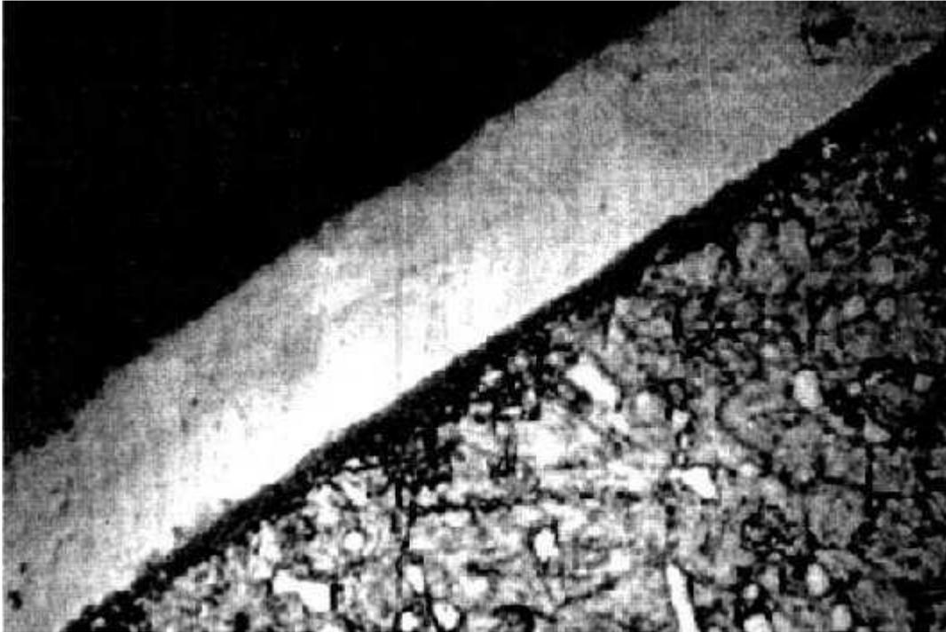
*Fig. 1.1 - Foto al microscopio ottico di un rivestimento in TiN. Si può ben notare l' elevatissimo grado di finitura superficiale che si può ottenere con tali rivestimenti*
