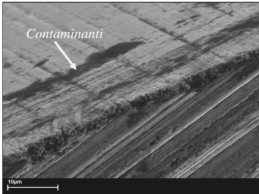
*Fig. 8.9 – Micrografia del tagliente principale non rivestito; si nota la presenza di contaminanti lungo il profilo affilato e fratturato dopo affilatura*
