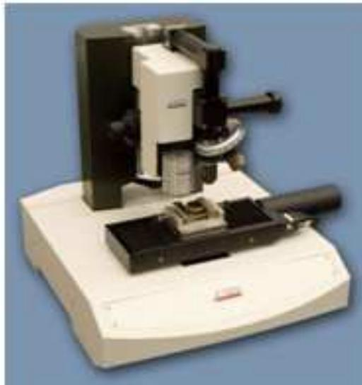
Il Table Top Tester è particolarmente indicato alla misura delle proprietà meccaniche di materiali per indentazione strumentata. Può essere utilizzato per la determinazione delle proprietà meccaniche di film sottili e di campione massivi ( bulk ). Proprietà come la nanodurezza e il modulo elastico possono essere determinate per qualsiasi
