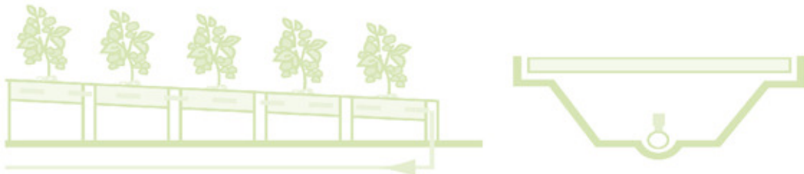
Fig. 1.7 - Rappresentazione del sistema a canaletta (Fonte: www.aeroponic.it ).
