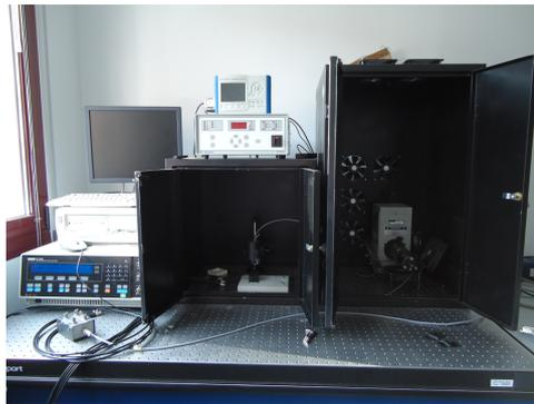
Figura 4.5: Disposizione del simulatore solare all'interno dei box sul banco di misura.
