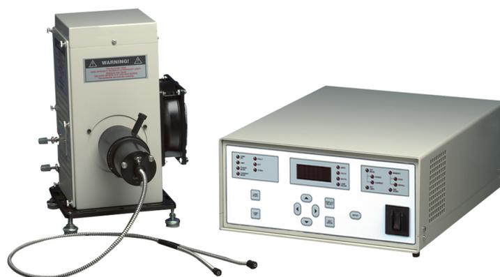
Figura 4.2: Simulatore solare Newport 96000.
