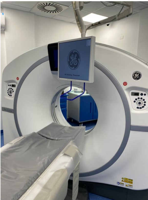
(Figura 32, TC Revolution EVO 128-Slices, gantry e lettino porta-pazienti)
