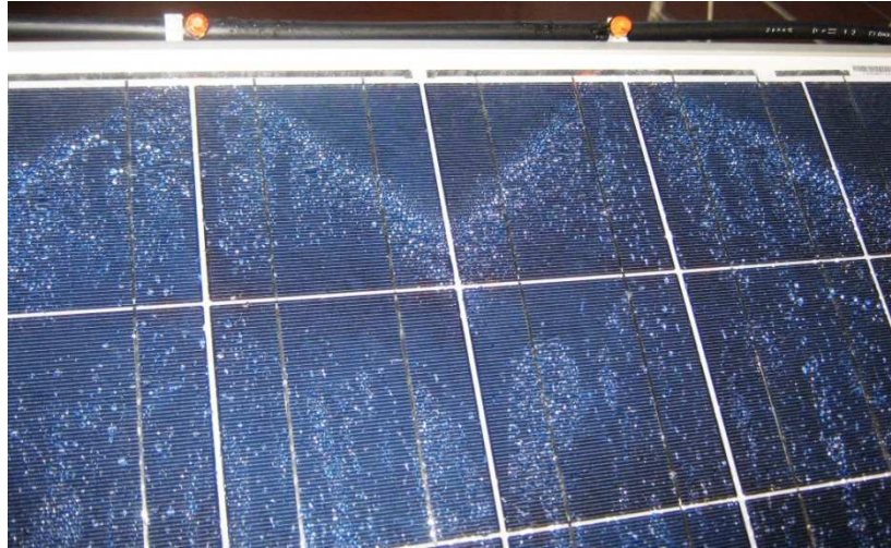
Figura 6.3: Fase post-interruzione della porta d'acqua. Si evidenziano le zone superiori completamente asciutte e le goccioline disperse sul resto della superficie.
