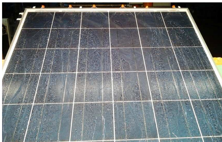
Figura 6.4: Prova con 6 microirrigatori in cui la portata risulta triplicata rispetto al caso iniziale; si ha miglioramento del film nella prima parte ma la rottura del film avviene comunque prima di metà superficie
