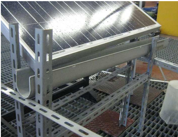
Figure 5.14 e 5.15: Sistema di recupero dell'acqua predisposto per le analisi sperimentali
