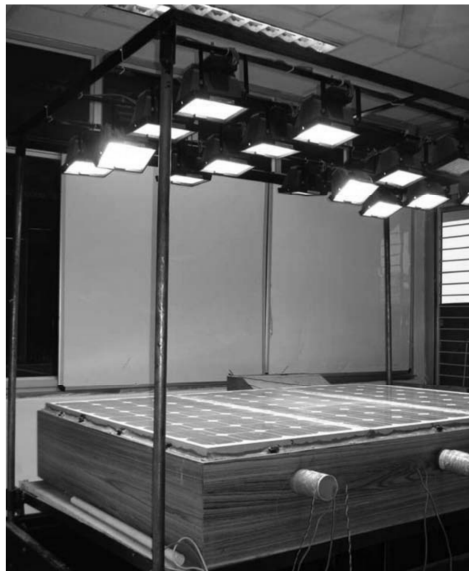
Figura 5.9: Apparato sperimentale utilizzato nello studio [19] per riprodurre la radiazione solare
