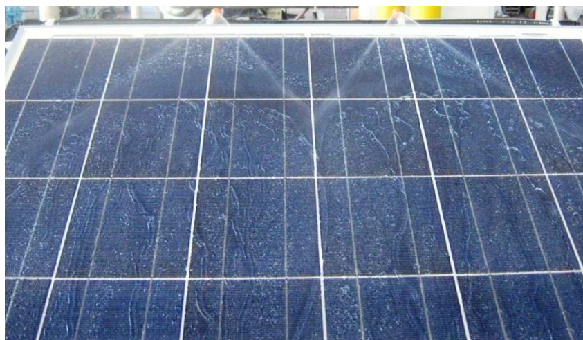
Figura 6.1: Distribuzione di una portata d'acqua pari a 0.02[l/s m 2 ] sulla superficie del pannello. Si evidenzia il film nella prima parte e i fili d'acqua che si formano dopo la rottura del film; tutto intorno le goccioline d'acqua che interessano la totalità della superficie
