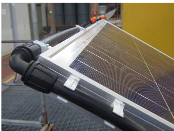
Figura 5.7: Raccordo a gomito del sistema di raffreddamento. Si riconoscono gli ugelli Claber posizionati nel bordo superiore.
