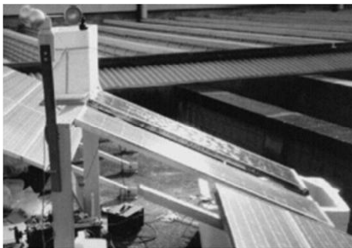
Figura 2.1: Vista dei due pannelli; si nota la tanica posta sopra il pannello da raffreddare e l'acqua sulla superficie frontale
