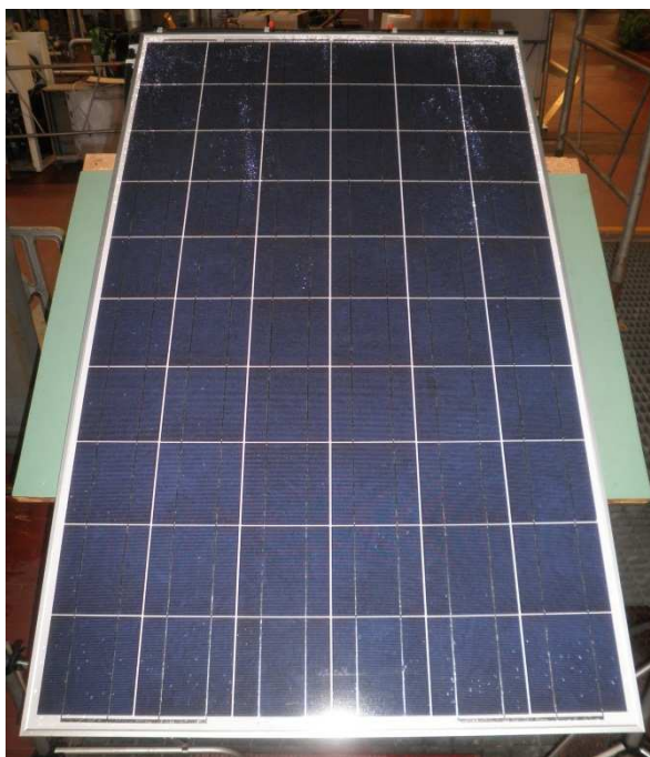
Figura 5.2: Vista frontale dell'installazione del pannello fotovoltaico sul banco inclinato
