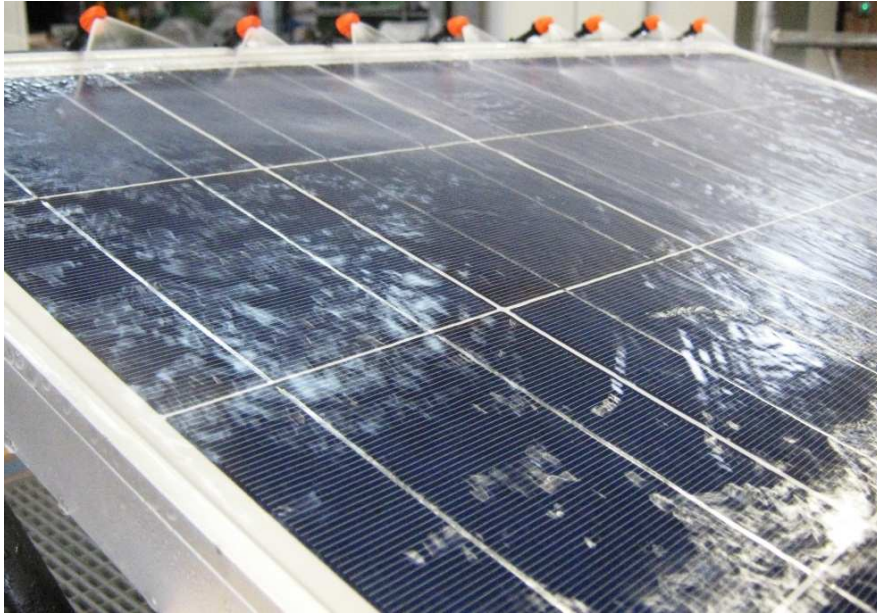
Figura 6.6: Formazione del film d'acqua sulla superficie del pannello fotovoltaico con 9 ugelli; portata specifica 0.09[1/s\ m^2]
