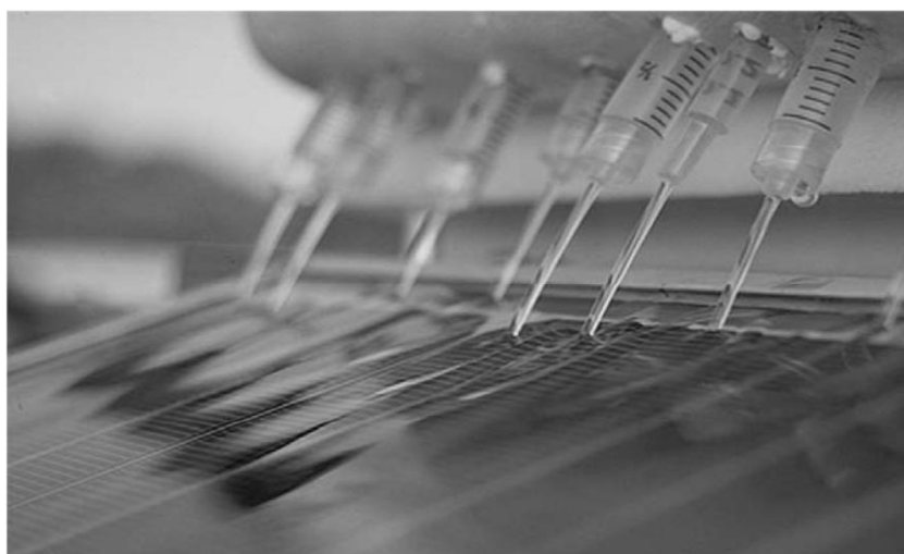
Figura 2.2: Dettaglio degli ugelli utilizzati; si vede il film d'acqua che scorre sulla superficie.
