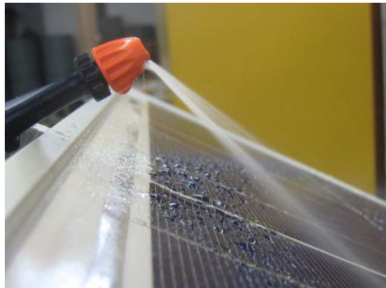
Figura 5.8: Particolare del microirrigatore Claber, con astina per migliorare la posizione del getto. La posizione adottata durante le prove prevedeva il completo appoggio della astina di supporto al bordo del pannello così da alzare il punto di contatto getto-pannello.
