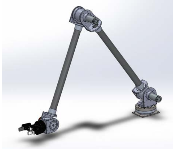
Figura 4.5: Braccio robotico a 4 gradi di libertà con il gripper 2F-85 della Robotiq [4]
