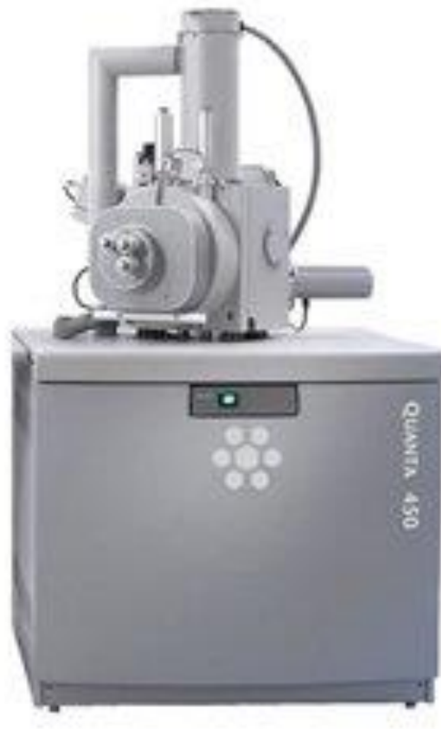
Figura 5.22 SEM FEI Quanta 450 utilizzato per rilevare i difetti superficiali.
