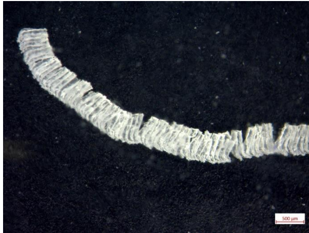
Figura 5.30 Truciolo segmentato di PA6.
