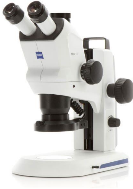
Figura 5.28 Stereomicroscopio utilizzato per la caratterizzazione dei trucioli.
