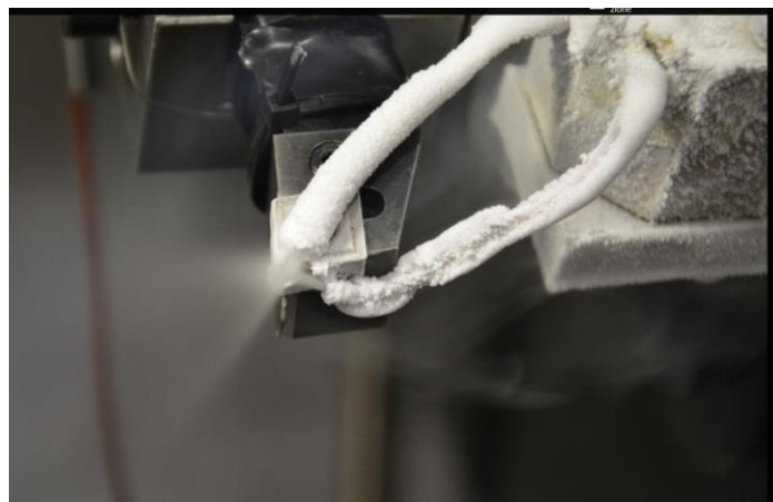
Figura 4.3 Foto del doppio ugello da cui fuoriesce azoto liquido.
