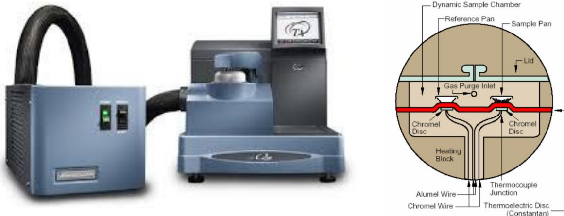
Figura 5.4 DSC Q200 TA utilizzata (a sinistra) e dettaglio della piattaforma termoelettrica dove vengono inseriti i campion (a destra).
