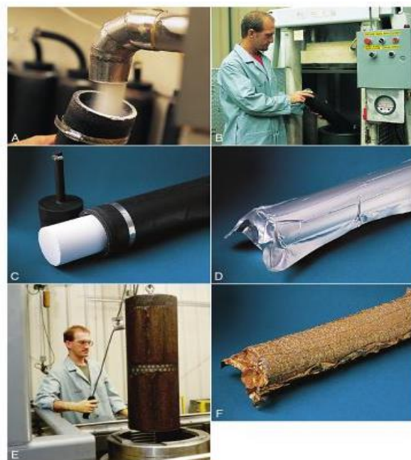
Figura 2.13 Produzione di una barra di UHMWPE a partire da polvere tramite formatura isostatica a caldo.
