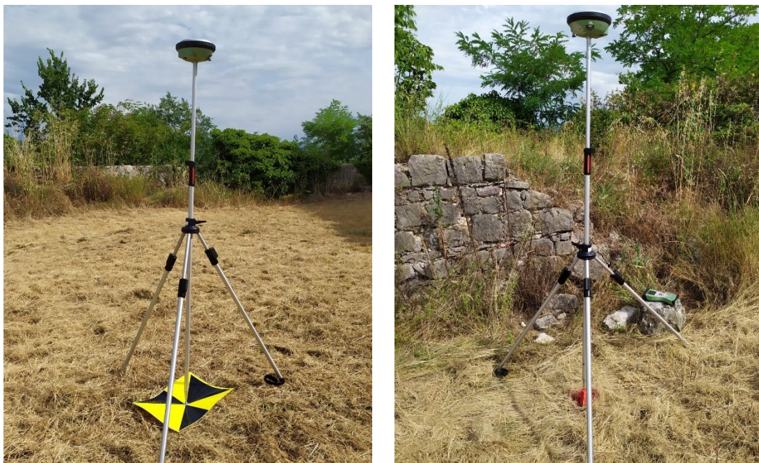
Figura 2.15. GPS Leica Viva GS14 posizionato su treppiede per target I.D. 6 a sinistra, e stazione I.D. 4000 a destra.
