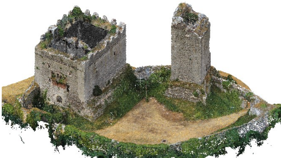
Figura 2.17. Vista isometrica nord-ovest ottenuta dall'allineamento delle nuvole di punti provenienti da laser scanning e da fotogrammetria ( CloudCompare ).
