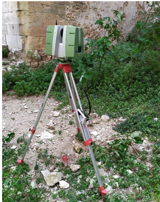
Figura 2.14. Laser scanner Leica ScanStation P20 su treppiede per I.D. 7000.
