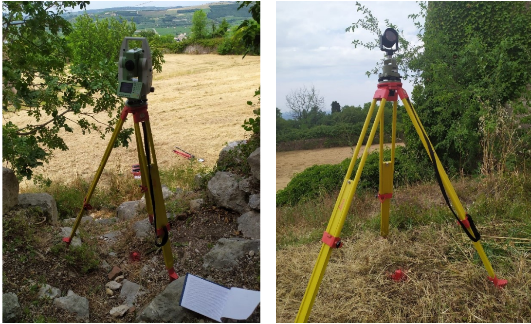
Figura 2.13. Stazione integrata Leica TCR1201 su treppiede per I.D. 5000 a sinistra, e prisma su treppiede per I.D. 1000.
