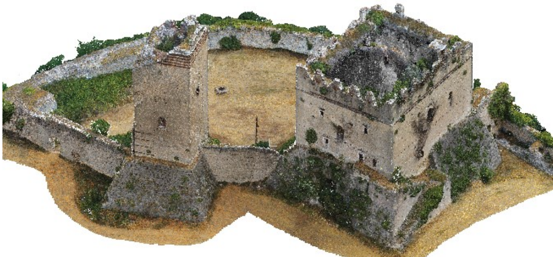
Figura 2.16. Vista isometrica sud-est ottenuta dall'allineamento delle nuvole di punti provenienti da laser scanning e da fotogrammetria ( CloudCompare ).
