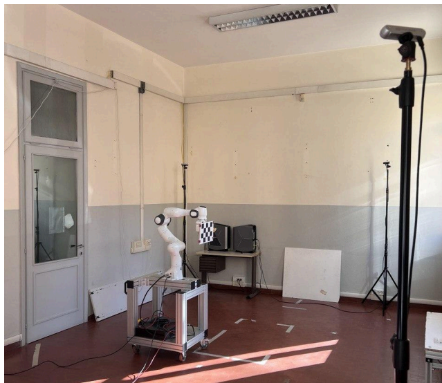
Figura 1.2: Foto del setup di laboratorio in cui si possono distinguere un braccio robotico monitorato da una rete di telecamere, ciascuna posizionata sull'asta di un treppiede [B9]
