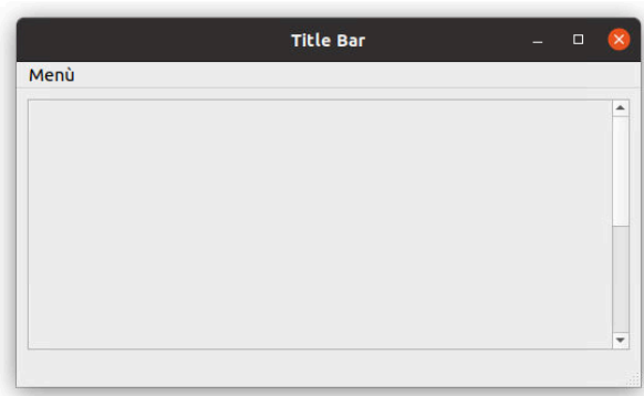
Figura 2.1: Finestra di esempio (senza contenuto), in cui si possono distinguere le sue componenti: la barra del titolo (title bar) in alto, i bordi, una barra di scorrimento (scroll bar) sulla destra e i pulsanti di controllo (control buttons) nell'angolo in alto a destra
