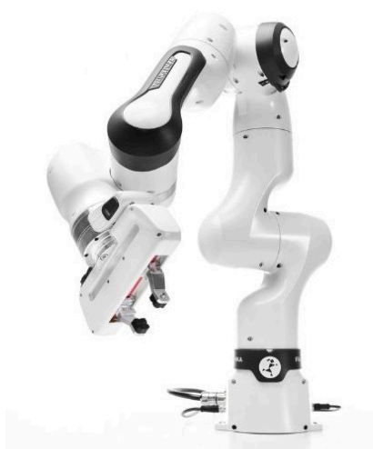
Figura 1.1: Esempio di robot che sarà oggetto in questa trattazione, il Braccio robotico Franka Research 3 [S2]
