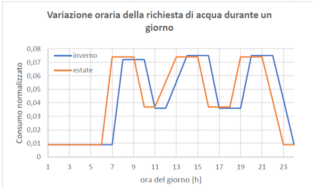
Figura 32 Curve orarie normalizzate della domanda di acqua
