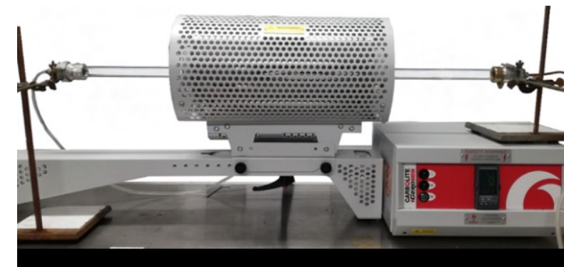
Trattamento termico: fornace tubolare orizzontale
