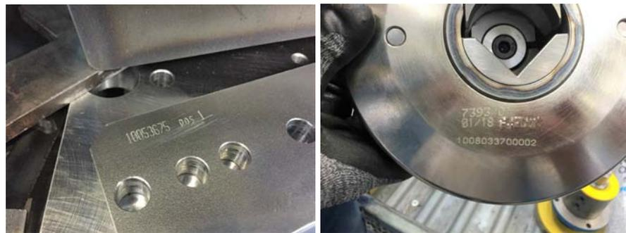
Figura 59: Esempio di componenti con marcatura realizzata dal fornitore.
