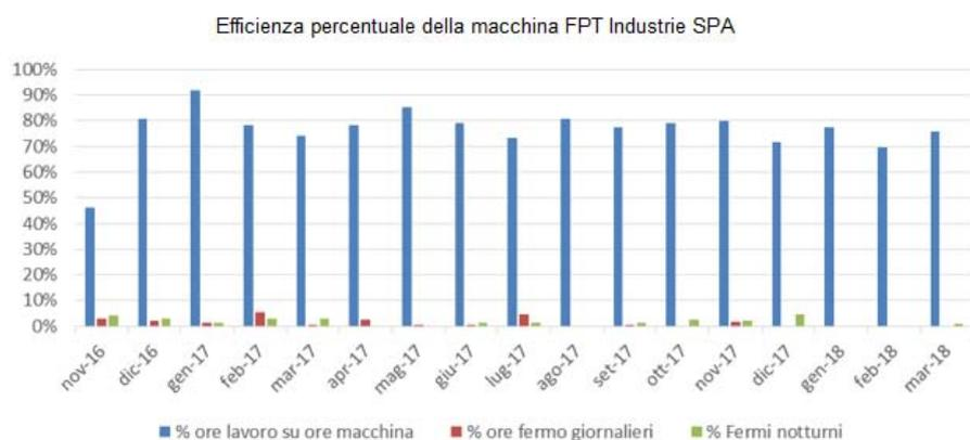
Figura 62: Indici di efficienza della macchina utensile in percentuale.
