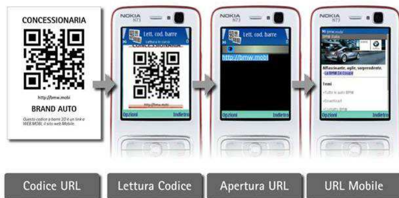
Fig. 5.14: Funzionamento dei codici QR
