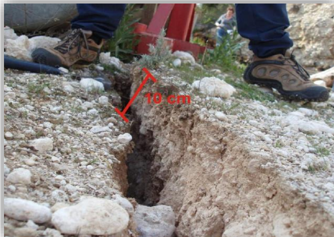
Fig.8 – Effetti ambientali di fratturazione superficiale dovuto al movimento della faglia di Paganica, in seguito definita Capace da Rilievi geologico-ambientali in fase emergenziale nell'area epicentrale del terremoto del 6 Aprile 2009 a L'Aquila, M 6.3: Primi Risultati di Andrea Berlusconi, Franz Livio, Alessandro M. Michetti e Giancanio Sileo
