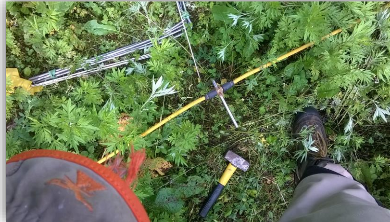
Fig.29 – Particolare del cavo multiconduttore per Syscal ed elettrodo di contatto inserito nel terreno
