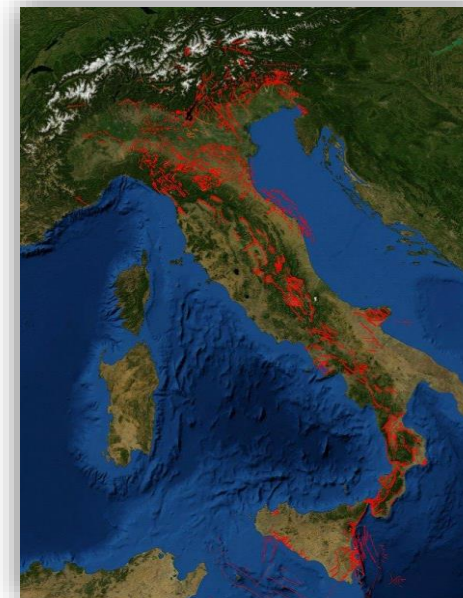
Fig.10 -Il catalogo ITHACA ( IT aly H azard from CA pable faults) colleziona le informazioni disponibili sulle faglie capaci, cioè le faglie che potenzialmente possono creare deformazione tettonica permanente in superficie, che interessano il territorio italiano.
