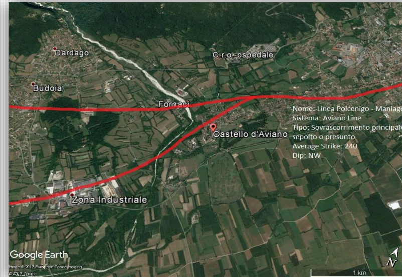
Fig.6 - Rappresentazione con Google Earth del Sovrascorrimento principale, oggetto di studio, come interpretato nella Carta Geologica del FVG in scala 1:150'000
