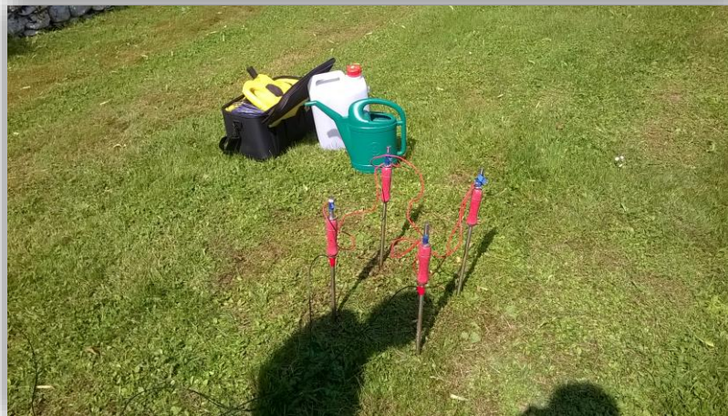
Fig.30 – Particolare del quadrupolo energizzante per sistema IRIS Full Waver
