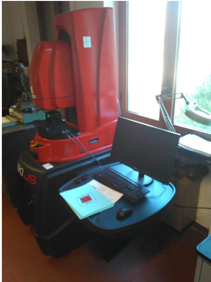
Figura 37:Macchinario per la microdurezza Vickers completamente automatizzato e con microscopio ottico integrato.
