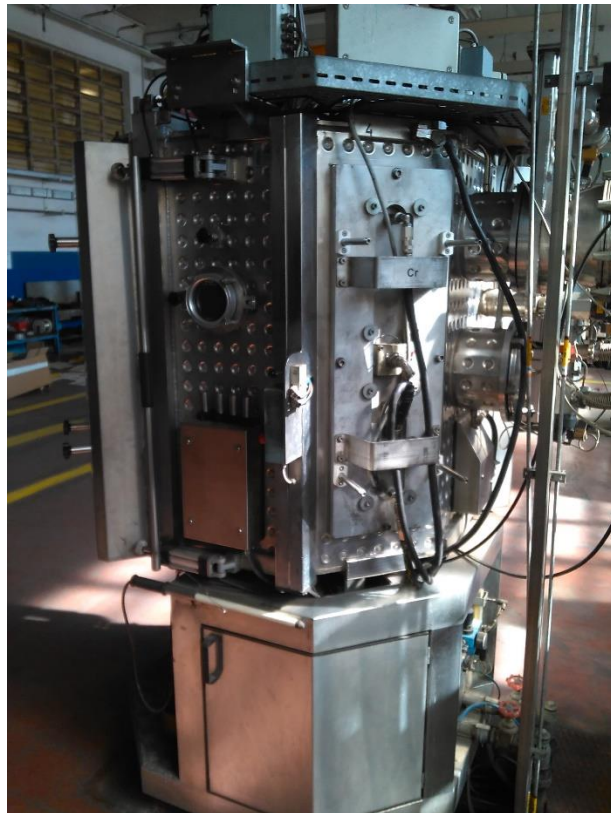
Figura 23: Impianto di deposizione PVD ad arco catodico per substrati di piccole dimensioni.
