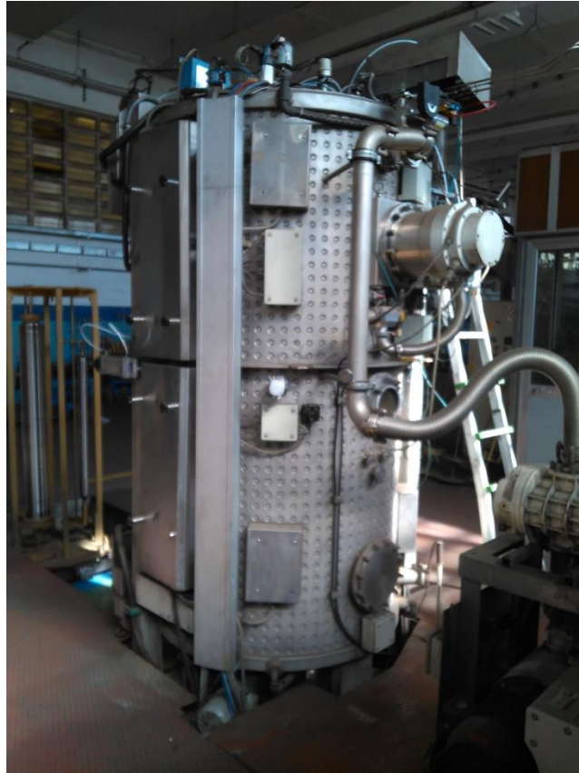
Figura 22: Camera di deposizione PVD ad arco catodico per substrati molto grandi.
