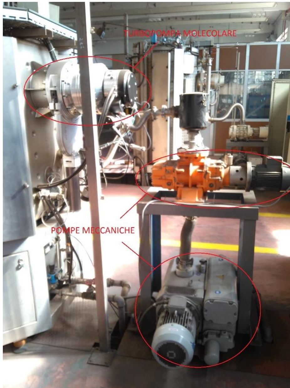
Figura 26: Sistema di pompaggio in serie , camera di deposizione per pezzi di piccola taglia.
