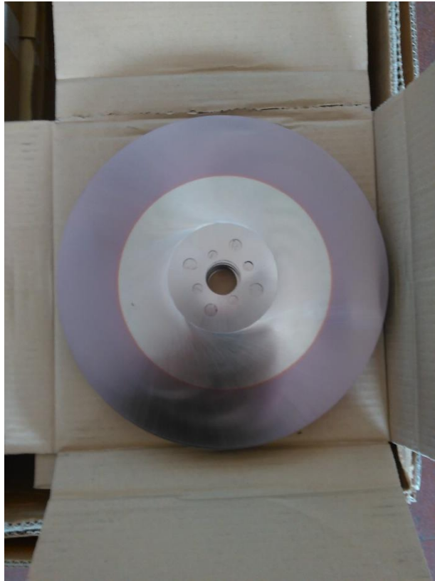
Figura 16:Dischi di sega circolare rivestiti con ZrN , si distinguono dal CrN per il loro colore più chiaro.
