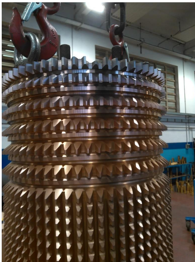
Figura 14: Broccia da 900 Kg, altezza 3m, diametro 1 metro, rivestimento TiN.
