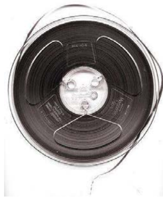
FIGURA 2.1: Un nastro magnetico da 1/4 di inch alloggiato su un bobina da 7 inch
