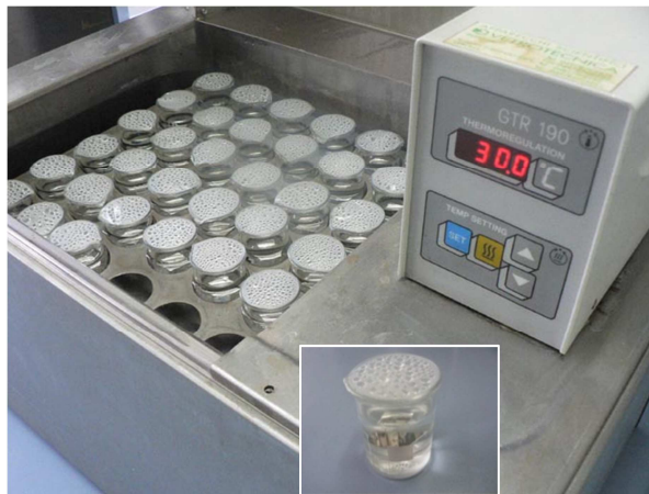
Figura 4.2 – Campioni in soluzione di Cl in bagno termostatico
